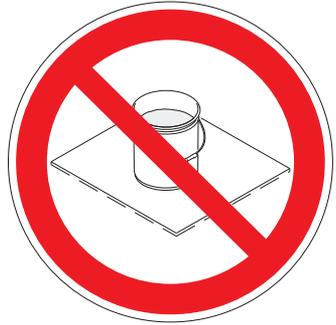
**Metalleimer müssen immer geerdet werden:** Einen Erdungsleiter am Eimer anbringen. Ein Ende am Eimer und das andere Ende an einem guten Erdungspunkt wie z. B. einem Wasserrohr anbringen.
