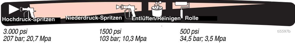
Zur Funktionsauswahl das Symbol am Druckreglerknopf auf die Einstellanzeige am Spritzgerät ausrichten.
