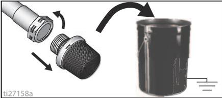
10. Den Gartenschlauch mit dem Hochdruckspülaufsatzventil am Saugrohr anschließen. Das Ablassrohr im Abfallbehälter lassen.
