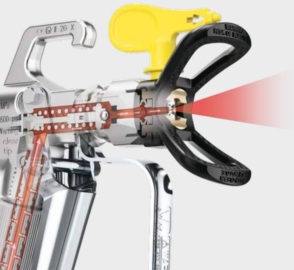
Bei der Airless- (luftlosen) Zerstäubung wird das Material im Gegensatz zur Luftzerstäubung allein über den Materialdruck, also ohne Luft, zerstäubt.
